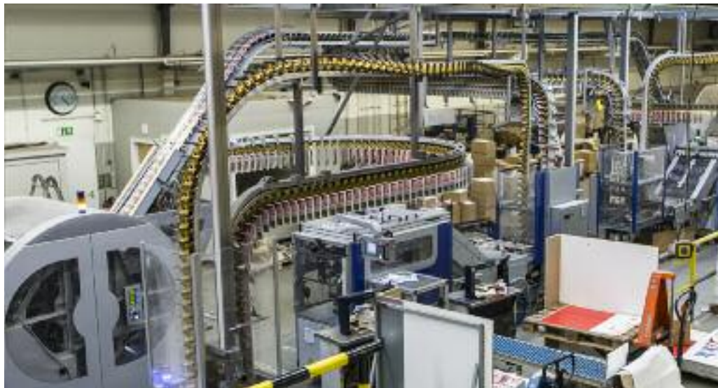
Eines der beiden Ferag-Easy-Sert-Einstecksysteme bei Avosmedia, eine dritte Einstecklinie ist bereits bestellt.
